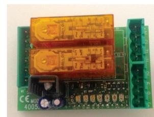
Le centraline Silmar mod. 4005 e 4005.4 sono realizzate in conformità alle normative CE della direttiva macchine 2006-42-CE-EN61496-1-2. Utilizzano relé di sicurezza a contatti guidati collegati in modo ridondante, garantendo anche in caso di guasti la funzionalità del circuito di emergenza e la disattivazione dei carichi pericolosi.
