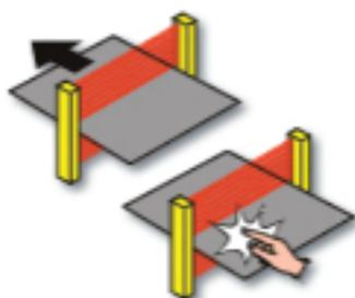
Barriere fotoelettriche anti-intrusione uomo ad assorbimento di infrarossi frontale
