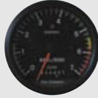
Nuovo Contagiri Ø 80mm per Rotax 912 completo di contaore, contaminuti motore e spia di fuorigiri a 5800 RPM. Movimento smorzato al grasso di silicone. Completo di archi colorati.
