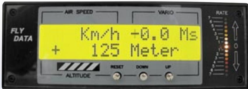
Strumento elettronico che visualizza i parametri fondamentali del volo.
