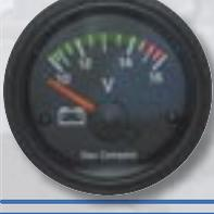
**Indicatore stato batteria voltmetro**
