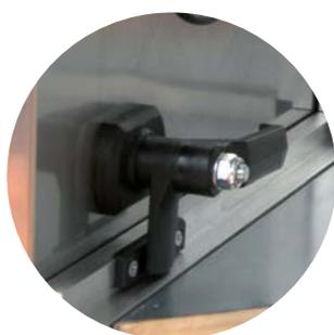
Gli oblò sono a doppia parete di policarbonato con guarnizione di tenuta. Grazie al sistema di fissaggio, che prevede il bloccaggio delle viti solo sulla struttura in policarbonato (e quindi non sul pannello sandwich) e alla dotazione di una guarnizione continua interno-esterno, si evita la formazione di condensa, garantendo la massima tenuta.
