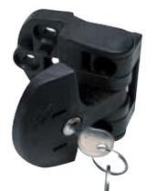
Le maniglie per l'apertura delle porte possono essere fornite, su richiesta, con scrocco regolabile in modo da poter ripristinare la tenuta nel corso del tempo. Viene sempre prevista una fascia antifrizione posta sul profilo dove fa tenuta la porta per evitare, dopo varie operazioni di chiusura, che la plastica dello scrocco (Nylon) si usuri.
