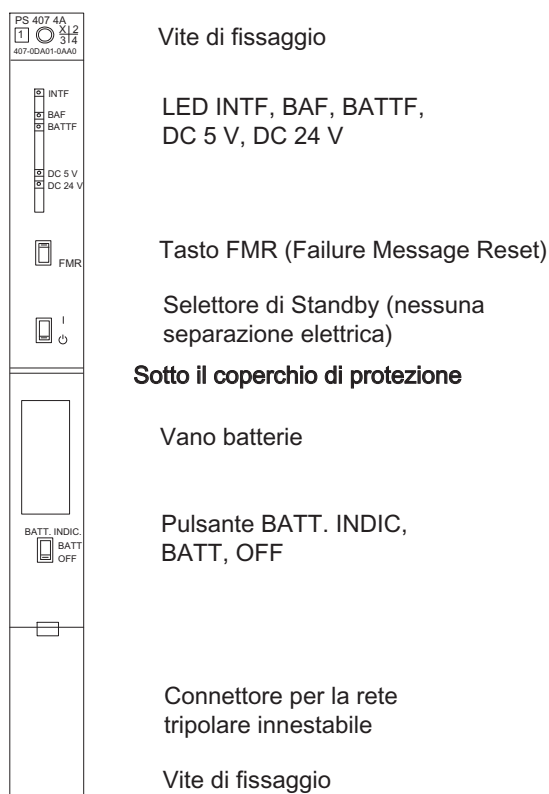
Figura 3-2 Elementi di controllo e LED del PS 407 4A
