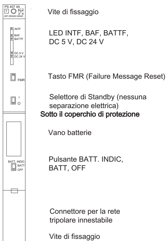
Figura 3-3 Elementi di controllo e LED del PS 407 4A
