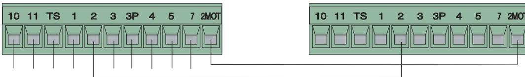
5) Assicurarsi che tutti i dip del quadro del 2° motore siano disattivati (OFF) tranne il dip 11. Importante: regolare i finecorsa dei motori in modo che, l'anta del motore MASTER arrivi in chiusura dopo della SLAVE.
