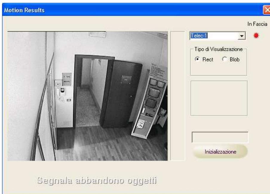
In questa finestra viene visualizzata l'analisi motion in tempo reale ed è possibile effettuare le impostazioni geometriche per il motion direzionale (paragrafo [9.7](#)).
