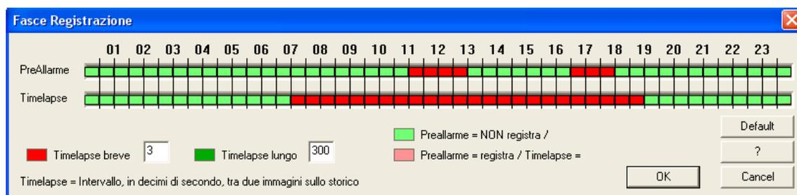
Nell'esempio della figura precedente, la registrazione avviene nella modalità *Timelapse breve* dalle 7 alle 19, e *Timelapse lungo* dalle 19 alle 7, mentre la modalità di preallarme è attiva solamente dalle 11 alle 13 e dalle 16:30 alle 18.
