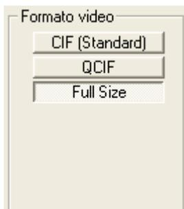
Per impostare il formato di registrazione delle sequenze riprese dalle telecamere (in termini di definizione dell'immagine) scegliere una delle seguenti opzioni nel riquadro **Formato video** del menu **PARAMETRI** (figura a lato):
