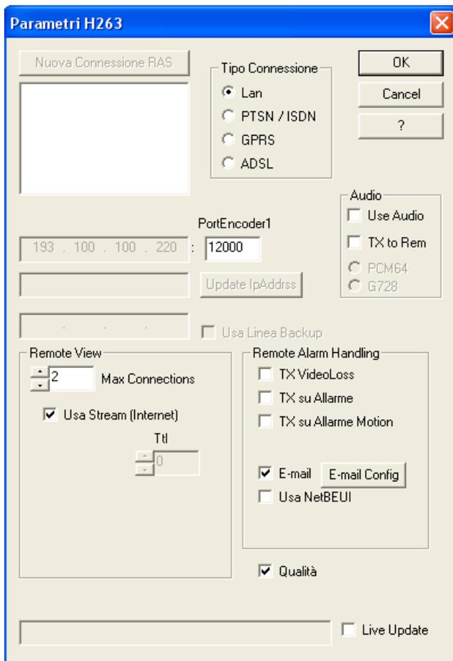
Nella finestra **Tipo connessione** si seleziona il mezzo di comunicazione per la trasmissione dei dati:
