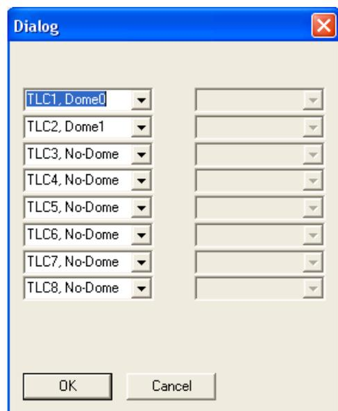
Cliccando su **PARAMETRI** → Assegnamento Dome compare la finestra (figura a lato) tramite la quale si imposta l'indirizzo delle telecamere Speed Dome collegate al sistema.
