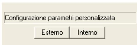
Prima di impostare i parametri seguenti, premere uno dei tasti **Interno** o **Esterno** (figura a lato) a seconda che la telecamera sia installata rispettivamente in un ambiente chiuso o all'esterno. In questo modo, i parametri vengono impostati secondo un criterio di base sviluppato da Teledata.
