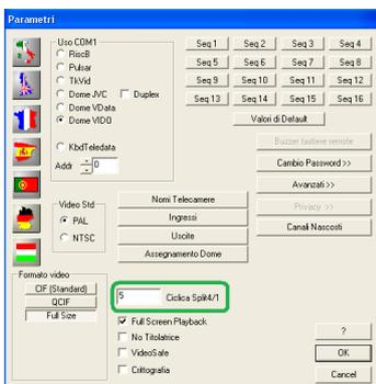
Se più telecamere sono selezionate, le sequenze provenienti da ciascuna di esse si alterneranno ciclicamente sullo schermo; per impostare la frequenza con cui si alternano le sequenze, cliccare su **PARAMETRI** e modificare l'impostazione **Ciclica Split4/1** (figura a lato). Impostare un valore basso se si vuole che le immagini cambino rapidamente.
