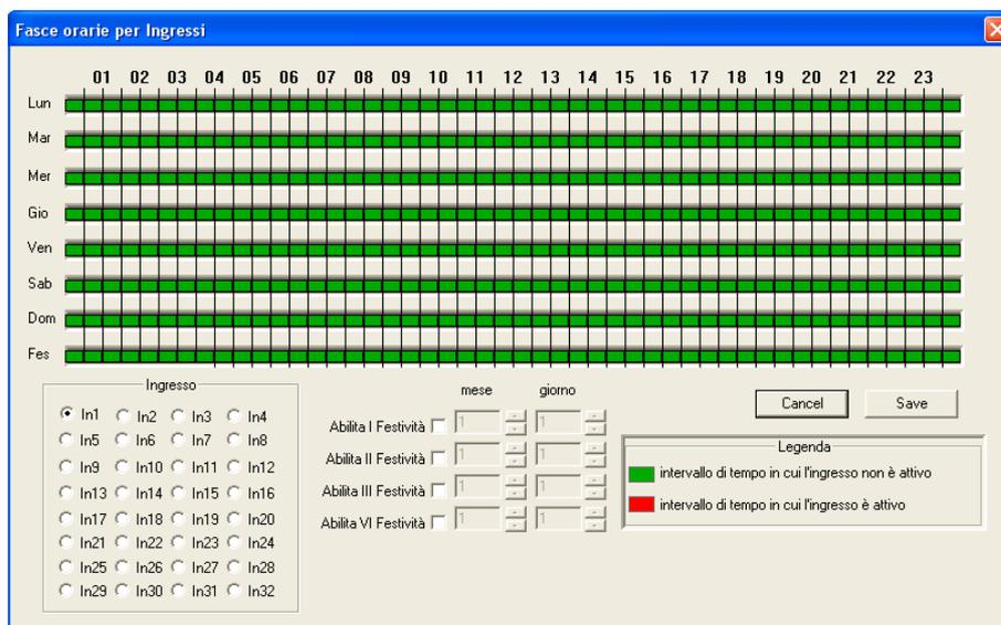
La programmazione delle fasce orarie per l'abilitazione degli ingressi si effettua in modo analogo alla programmazione delle telecamere (paragrafo [6.1.5](#)).
