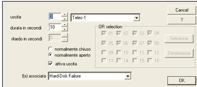
Cliccare sul tasto **Uscite** dal menu **PARAMETRI**; la finestra che appare (figura a lato) permette di associare una funzione a relè a ciascuna uscita dei connettori a 37 poli (fare riferimento al paragrafo [2.1.2](#) per la disposizione delle uscite).
