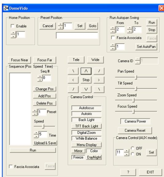
Una volta selezionato il protocollo di comunicazione fra le telecamere e il sistema di videosorveglianza, cliccando su **DOME SETUP** sulla schermata principale viene visualizzata la finestra (figura a sinistra) che dà accesso alle opzioni di configurazione delle telecamere Speed Dome collegate al sistema.
