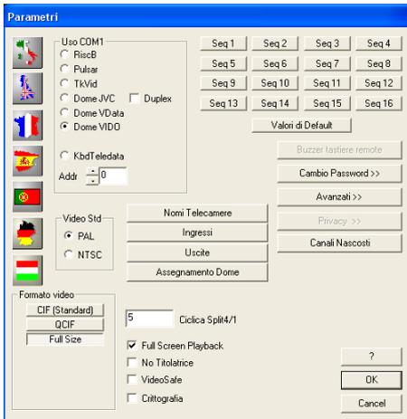
Premere il tasto **PARAMETRI** nella schermata principale del programma; la finestra che appare (figura a lato) dà accesso alle finestre di programmazione del sistema. La tastiera virtuale che appare in sovrapposizione (figura in basso) può essere usata per impostare i parametri.
