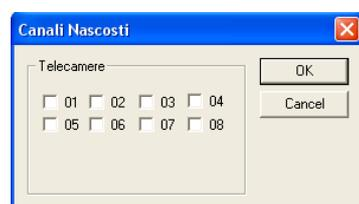
Per disabilitare provvisoriamente la visualizzazione delle immagini provenienti da alcuni ingressi sul monitor principale (SVGA), premere il tasto **Canali nascosti** dal menu **PARAMETRI** (figura a lato) e selezionare i canali (ingressi telecamere) interessati. Per riabilitare la visualizzazione delle immagini, deselegionare tutti i campi.
