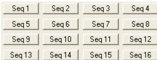
Premendo uno dei tasti in alto a destra sulla schermata principale (figura a lato) è possibile impostare una sequenza di visualizzazione delle telecamere sui monitor di servizio. Si possono impostare fino a 16 sequenze.
