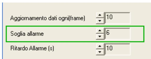
Questo parametro, impostabile in una scala da 1 a 25, indica la sensibilità dell'algoritmo rispetto alle variazioni di immagine delle sequenze analizzate:
