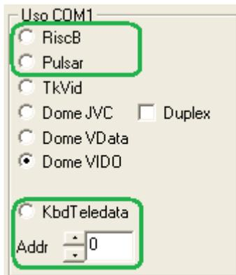
Se al connettore è stata collegata ad una centrale anti-intrusione Teledata, nel riquadro **Uso COM1** (figura a lato) selezionare il protocollo a seconda del tipo di centrale:
