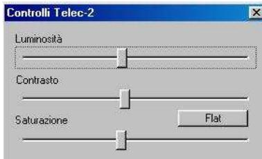
Per regolare il contrasto, la luminosità e la saturazione delle immagini, selezionare una sola telecamera per ciascun riquadro e fare doppio click con il tasto destro sul riquadro interessato: nella finestra che compare (figura a lato) agire sulle barre o premere il tasto **FLAT** per ripristinare i valori di fabbrica.
