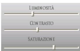
Per regolare il contrasto, la luminosità e la saturazione delle immagini, selezionare una telecamera alla volta (deselezionare tutte le altre) e agire sulle barre situate nella parte in basso dello schermo (figura a lato).
