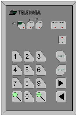
Il sistema è in grado di gestire fino a 4 tastiere remote TKVID Teledata (figura a lato), utilizzate per l'impostazione di alcuni parametri di funzionamento e per la segnalazione di eventuali allarmi tramite segnale sonoro e spie luminose.
