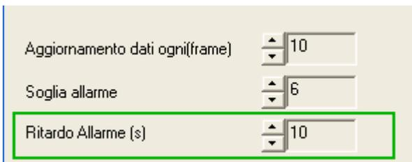
Una volta che il sistema ha rilevato una variazione permanente di immagine e si è messo in uno stato di preallarme (paragrafo [6.2.2](#)), prima di generare un allarme vero e proprio attende per un numero di secondi pari al valore impostato in questo campo.
