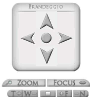
Se una telecamera con brandeggio è connessa al sistema di videosorveglianza, è possibile pilotare la telecamera utilizzando i tasti presenti nella schermata principale (figura a lato).
