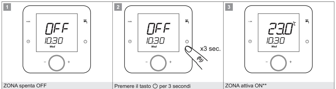
\*\* La pompa di calore ancora non funziona deve essere selezionata la modalità, riscaldamento,raffreddamento, auto oppure produzione acqua calda sanitaria.
