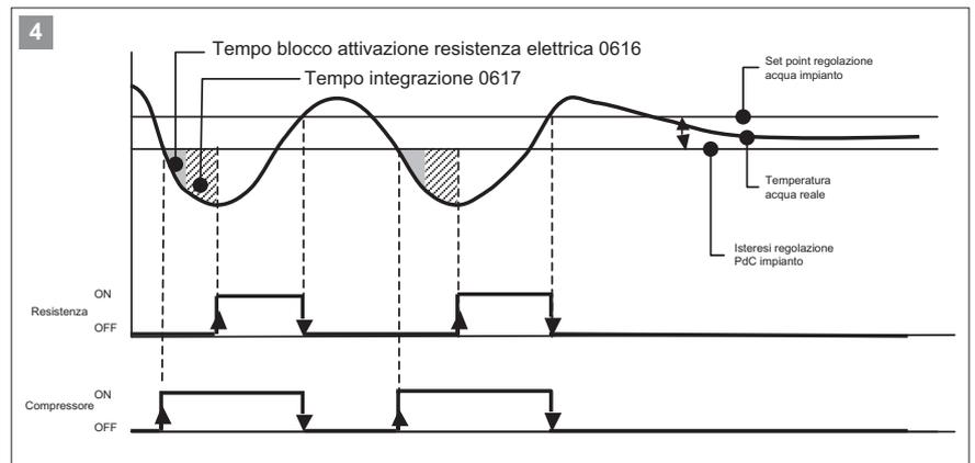
Una volta abilitata la resistenza, il riscaldamento integrativo viene attivato se raggiunto il valore dell'integrale impostato al parametro 0617 e trascorso il tempo di blocco 0616. Il tempo di blocco non viene rispettato alla prima accensione dell'unità.
