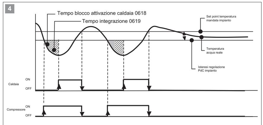
Una volta abilitata la caldaia, il riscaldamento integrativo viene attivato se raggiunto il valore dell'integrale impostato al parametro 0619 e trascorso il tempo di blocco 0618. Il tempo di blocco non viene rispettato alla prima accensione dell'unità.
