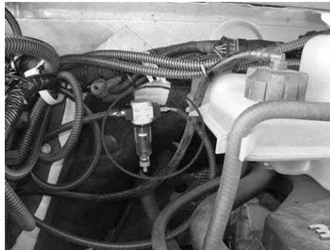
Filtro separatore condensa Light Duty (Veicoli Leggeri) - installazione
