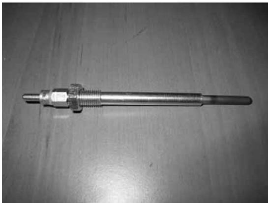
Successivamente è possibile avvitare, fino al termine del filetto, le candeelette, provviste di controdatto, nelle relative boccole con una coppia di 17 Nm.
