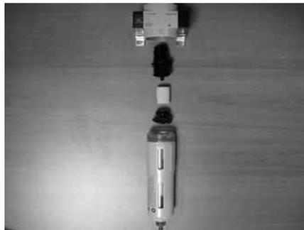
Filtro separatore condensa Heavy Duty (Veicoli Pesanti) - componenti
