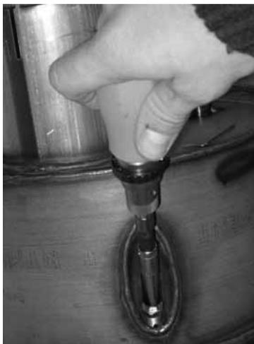
Per completare il fissaggio delle candele è quindi necessario stringere i grani a testa esagonale incassata M4x1, presenti nelle sedi, in modo da eliminare qualsiasi movimento relativo tra fondello e candele.
