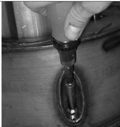
Serraggio candele mediante giravite
