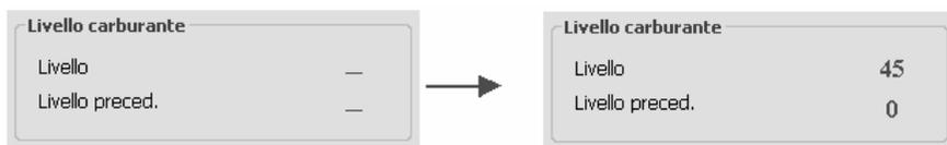
***Affinché il sistema funzioni correttamente è NECESSARIO effettuare il rifornimento a veicolo spento, altrimenti la centralina non riconoscerà l’aumento di livello e NON doserà l’additivo.***
