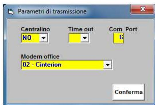
La presenza di centralino sottintende la composizione dello **zero** per l'acquisizione della linea telefonica esterna (Solo per Cod. 755056).
