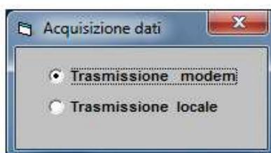
**La trasmissione modem è possibile solo con l'interfaccia FAST-TELE (cod. 755056) e perché sia operativa deve prevedere:**
