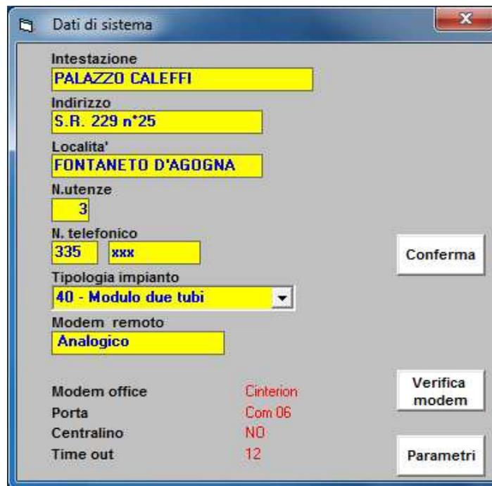
Premendo “Verifica modem” (Solo per 755056) è possibile verificare ed aggiornare i parametri di comunicazione del modem seriale esterno collegato al PC.
