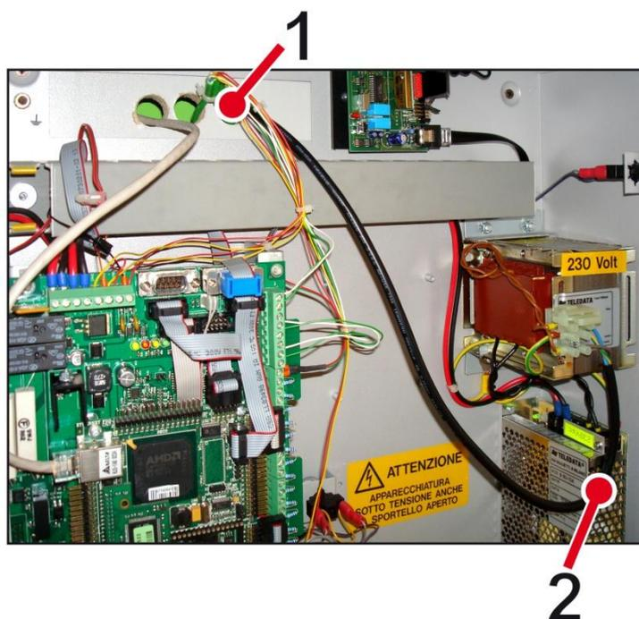
Con riferimento alla figura precedente, inserire i cavi di alimentazione elettrica attraverso l'apposito foro munito di passacavo (1) e fissarli vicino alla morsetteria di rete con apposita fascetta (2).
