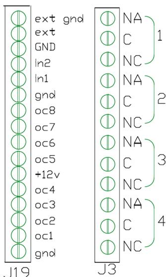
La prima morsettiera **J19** contiene i morsetti per le 8 uscite open collector (**OC1...OC8**) e due coppie morsetti per alimentazioni esterne a 12V:
