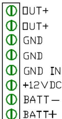
I morsetti **OUT+**, **OUT+**, **GND**, **GND** servono per portare l'alimentazione ai dispositivi esterni (assorbimento massimo di corrente: 800 mA per ciascuna uscita)
