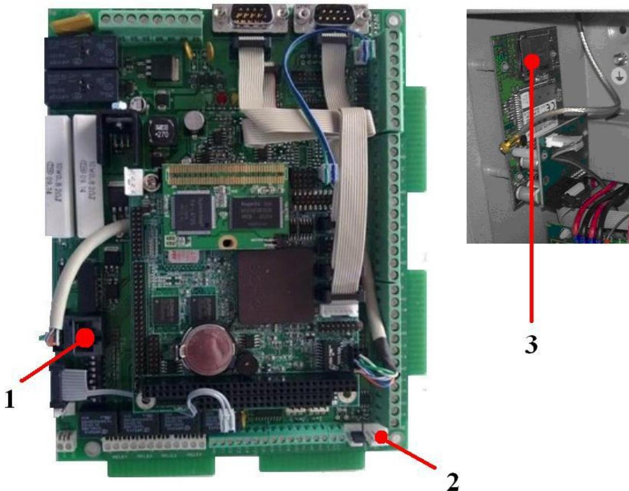
Verificare che i tamper (2) siano correttamente collegati sulla relativa morsetteria (paragrafo [2.3.1.2](#)). Provare a rimuovere il coperchio e la centrale per verificare il corretto funzionamento dei tamper.
