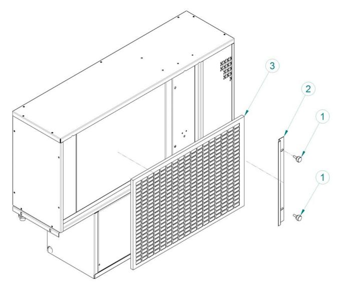
Svitare le due viti(1) rimuovere la guida(2), traslare verso destra il filtro(3) per circa due centimetri e quindi farlo scivolare verso il basso dopo aver estratto il bordo inferiore del filtro stesso oltre il piano d'appoggio.
