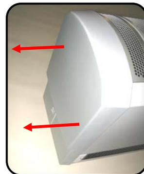
Poi rimuovere ogni griglia d'ingresso con il suo filtro svitando la vite Philips di un quarto di giro nell'angolo inferiore della griglia. Utilizzare un cacciavite Philips per accedere alla vite attraverso il foro allungato collocato nell'angolo inferiore della griglia e girare in senso antiorario per rimuoverla (vedi fotografia).
