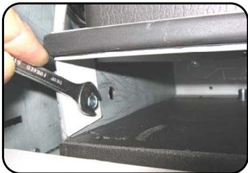
Utilizzando una chiave da 10mm allentare i due bulloni, uno ad ogni estremità dell'apertura dello scarico dell'aria, effettuando due giri. Non rimuovere questi due bulloni completamente.
