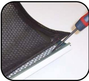
Rimuovere i filtri dell'aria dalle griglie d'ingresso dell'aria esercitando una leggera pressione per svincolarli. Aspirarli delicatamente e rimontarli nelle griglie d'ingresso dell'aria curve. I filtri sono resistenti ma devono essere sostituiti dopo una serie d'interventi di manutenzione.
