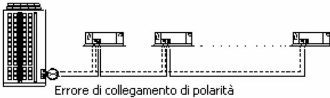
Errore di collegamento di polarità
