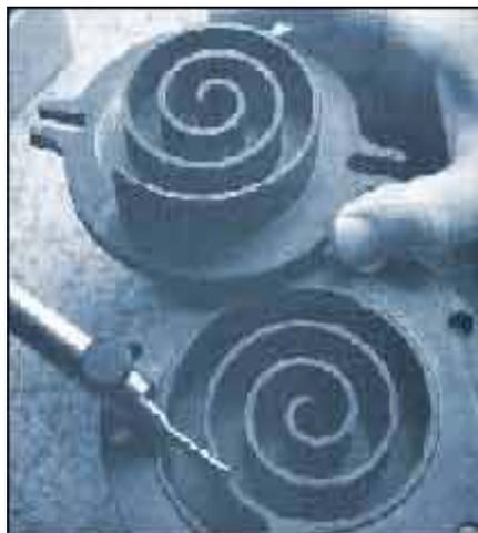
Il compressore **Digital Scroll™** è composto da una spirale fissa, una spirale orbitante, un motore, i tubi d'aspirazione e mandata ed un'elettrovalvola PWM. Questo compressore differisce dai classici compressori Scroll in quanto unisce la flessibilità della tecnologia del compressore ermetico assiale a spirale orbitante, ad un'elettrovalvola **PWM** (**P**ulse **W**idth **M**odulation = a modulazione d'ampiezza d'impulso).
