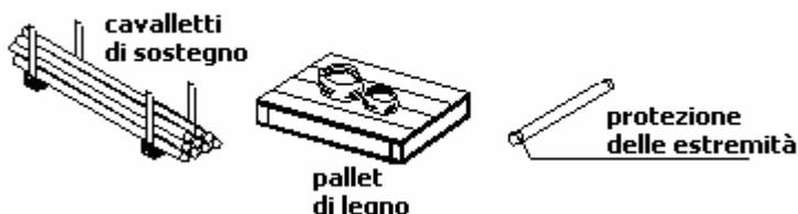
2. Le estremità aperte dei tubi necessitano di protezione. Il metodo migliore è quello consistente nella sigillatura delle estremità, oppure quello della nastratura. La seguente tabella fornisce indicazioni di massima legate allo stoccaggio in cantiere:
