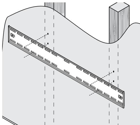
**5** Assicurarsi che la piastra di montaggio a parete sia a livello utilizzando l'apposita livella a bolla d'aria. Appoggiare la livella fornita sulla piastra di montaggio a parete e accertarsi che la parete sia diritta nel senso orizzontale. Tenere saldamente la piastra in posizione.
