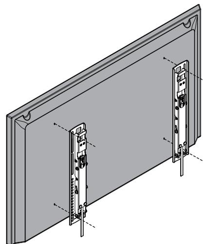
**1** Trovare i fori filettati nel pannello posteriore del televisore. Inserire una vite tra quelle fornite a mano in uno dei fori per essere sicuri di aver scelto quella giusta.
