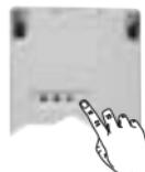
Premete per meno di 2 sec il **pulsante di programmazione** del ricevitore esterno. La spia di programmazione si accende per breve tempo.
