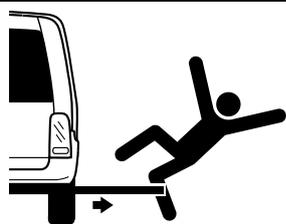
**Dopo aver sganciato manualmente la piattaforma, spingere completamente verso l'interno la maniglia a T di sblocco manuale e accertarsi che la piattaforma sia bloccata prima di mettersi alla guida del veicolo. Un'apertura involontaria o incontrollata della piattaforma (con uscita accidentale) potrebbe causare gravi lesioni e/o danni alle cose.**
