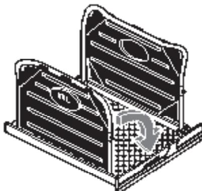
3. Sollevare la manopola rotonda di bloccaggio per liberare il dispositivo di bloccaggio e ripiegare il maniglione anteriore (destro) sulla piattaforma (posizione orizzontale).
