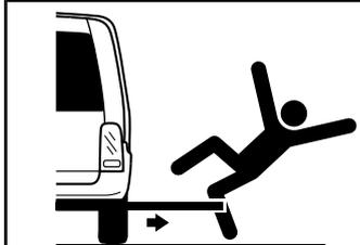
Dopo aver sganciato manualmente la piattaforma, spingere completamente verso l'interno la maniglia a T di sgancio manuale e accertarsi che la piattaforma sia bloccata prima di mettersi alla guida del veicolo. Un'apertura involontaria o incontrollata della piattaforma (con uscita accidentale) potrebbe causare gravi lesioni e/o danni alle cose.
