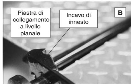
La piastra di collegamento manuale colma il vuoto tra la piattaforma del sollevatore e il pianale del veicolo nel momento in cui la piattaforma è completamente sollevata (posizionata a livello del pianale). Essa funge anche da fermo antiribaltamento interno.
