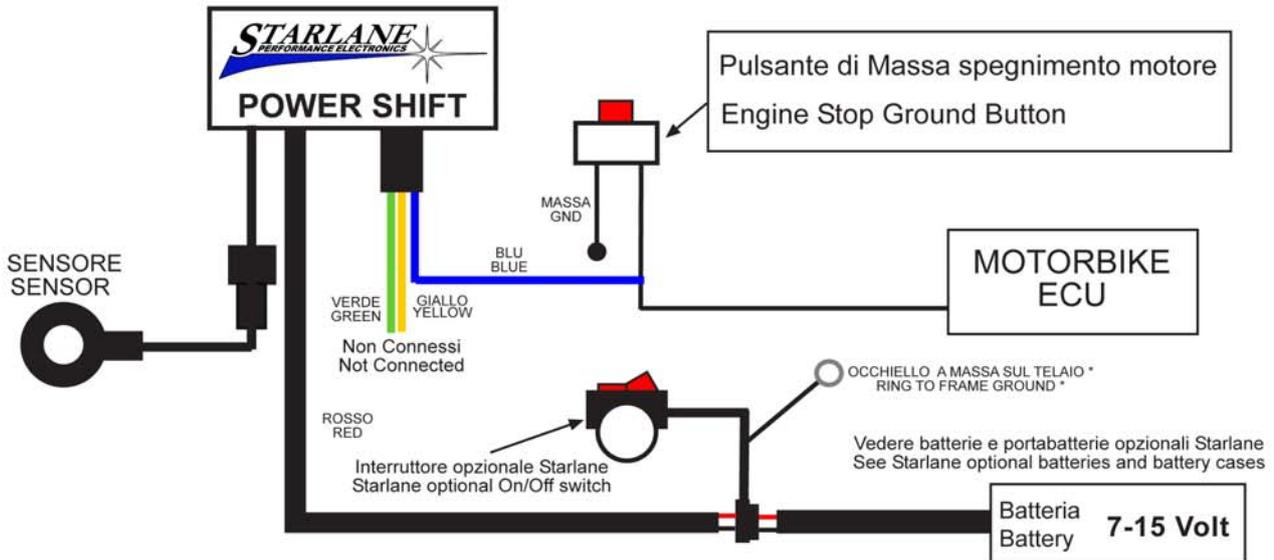
\*Nota:il sistema può funzionare solo se il negativo dell'alimentazione viene messo in comune con l'impianto o il telaio del veicolo
