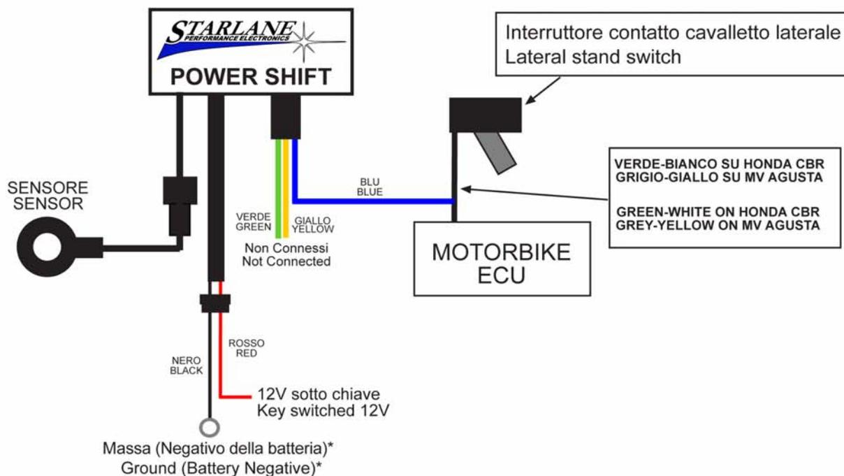
\*Nota: il sistema può funzionare solo se il negativo dell'alimentazione viene messo in comune con l'impianto o il telaio del veicolo
