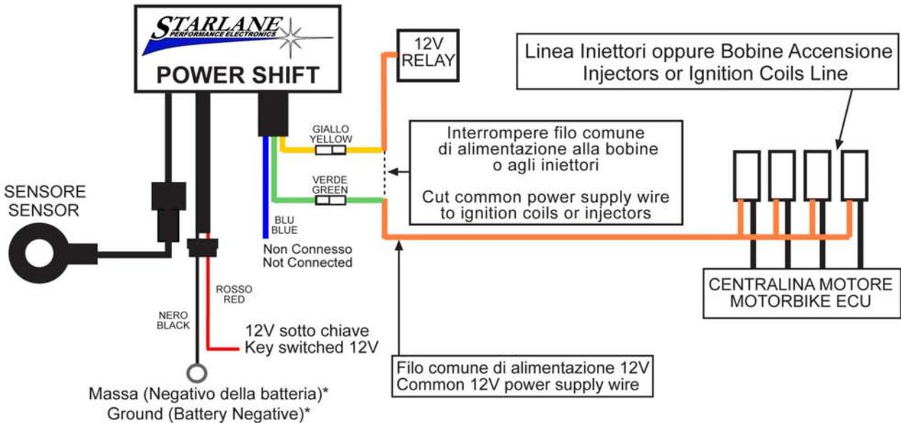
\*Nota:il sistema può funzionare solo se il negativo dell'alimentazione viene messo in comune con l'impianto o il telaio del veicolo
