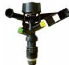
**Caratteristiche:** attacco maschio da 1/2" - angolo di traiettoria: 24° - gittata 10 ÷ 12,5 metri - filtrazione raccomandata 60 mesh - pressione di lavoro 2,5 ÷ 4,0 bar.
