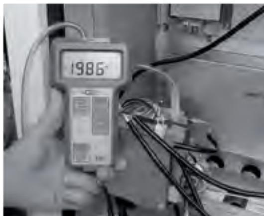
**Verifiche della pressione di iniezione a calore massimo**
