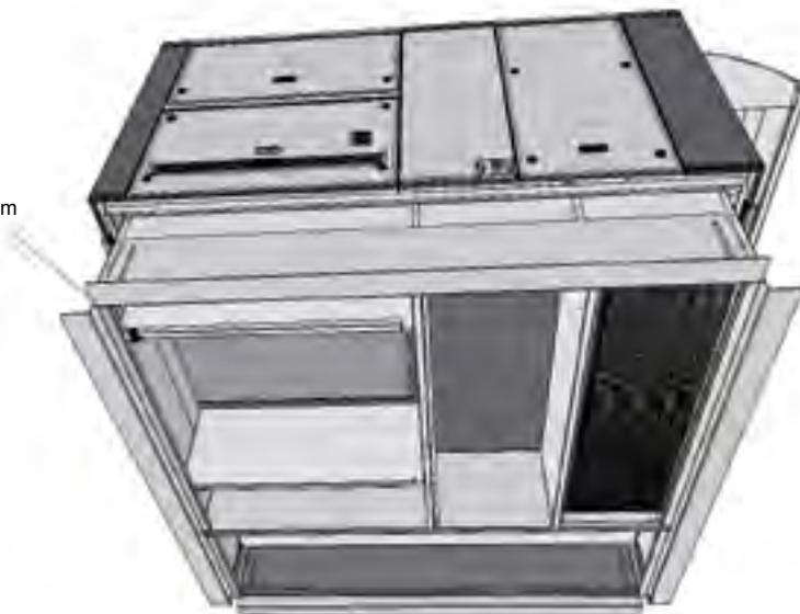
Telaio di montaggio a tetto non regolabile
