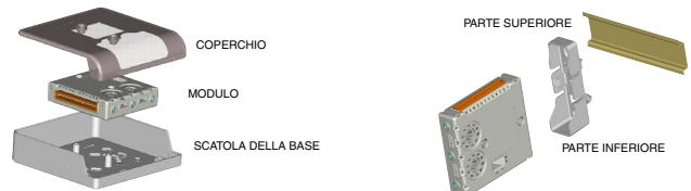
FIGURA 1: METODI DI MONTAGGIO DEL MODULO
