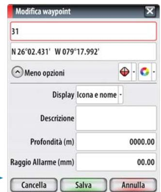
→ **Nota:** il raggio di allarme di ciascun waypoint deve essere attivato (ON) nel riquadro allarme per attivare un allarme ogni volta che l'imbarcazione entra nel raggio di azione impostato.
