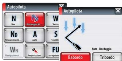
In entrambe le modalità, finché la finestra di dialogo del bordeggio è aperta, è possibile interrompere l'operazione di virata selezionando la direzione di bordeggio opposta. Dopo l'interruzione, la barca torna all'angolo di rotta precedentemente impostato.
