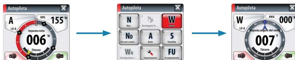
La rotta di governo (CTS) e l'angolo di vento impostati sono immessi dall'angolo di rotta della bussola e dal trasduttore vento nel momento in cui viene selezionata la modalità VENTO. Da lì in poi il pilota automatico modificherà la rotta per mantenere l'angolo di vento qualora la direzione del vento dovesse cambiare.
