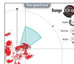
Una volta posizionate, è possibile attivare o disattivare rapidamente le zone di guardia toccando le rispettive sezioni sulla barra dati (solo NSS8 e NSS12).
