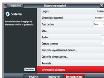
Il menu delle impostazioni di sistema consente l'accesso alle impostazioni avanzate per il sistema e determina il modo in cui vengono visualizzate varie informazioni dell'interfaccia utente sullo schermo.
