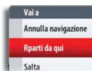
Una volta avviata la navigazione, il menu **Vai a** si estende in modo che vengano visualizzate le opzioni per ignorare un waypoint o per riavviare la rotta dalla posizione corrente dell'imbarcazione.
