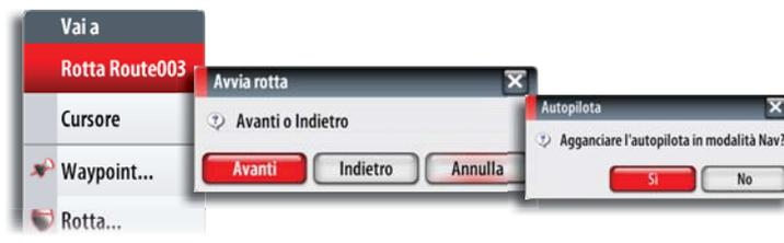
Se si sceglie di non attivare il pilota automatico, è possibile ugualmente impostarlo come modalità di navigazione in un secondo momento tramite il menu Pilot (Pilota).
