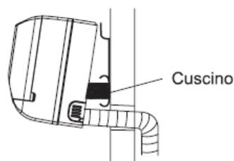
4. Spingere la parte inferiore dell'unità interna contro la piastra in modo da ancorarla. Successivamente muovere l'unità interna da un lato all'altro, su e giù per verificare che sia agganciata in modo sicuro.
