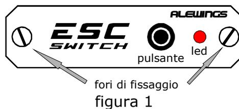
Posizionare il pannello esterno e tracciare le sagome interne del pulsante e del diodo led. Una volta realizzate tutte le aperture, posizionare il pannello esterno e fissare dall'interno il dispositivo con le viti in dotazione.
