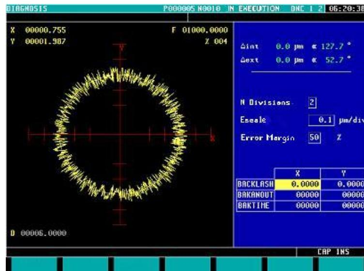
Se i parametri macchina sono protetti, chiederà la password di accesso, poiché in basso a destra sono visualizzati solo alcuni di essi. Se non si sa la password, non si potrà modificare tali valori, ma si accederà alla schermata e al test di geometria della circonferenza.
