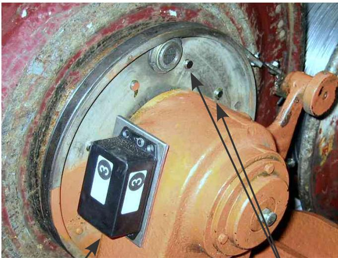
Trasmettitore con sensore incorporato
