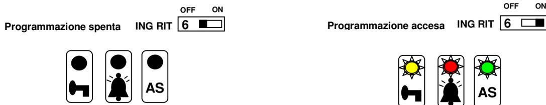
A programmazione accesa il led di stato e di allarme si accenderanno e il led di AS lampeggerà. In questa fase pigiando sul pannello il pulsante di ingresso si accenderà il led corrispondente.
