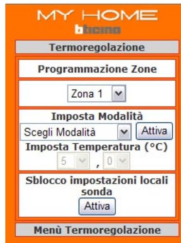
È inoltre possibile effettuare uno “sblocco” delle impostazioni della singola zona (sonda) per riattivarla qualora sia stata localmente impostata in OFF o antigelo/protezione termica.
