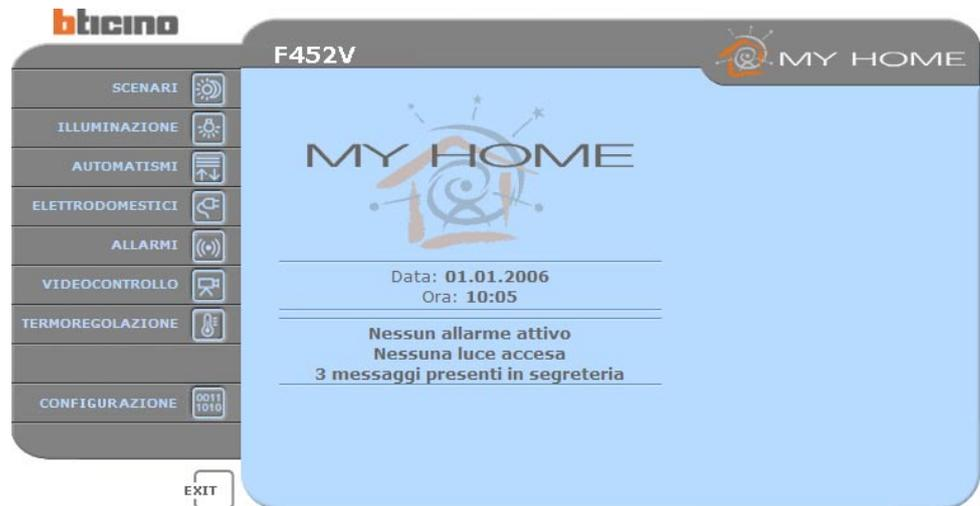
In qualsiasi momento è possibile controllare lo stato del sistema premendo il tasto
