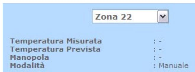
Se invece il collegamento del bus è interrotto, non c'è alimentazione sull'impianto oppure il Web Server Video non comunica, verranno visualizzati su tutte le voci solo una serie di trattini "-":
