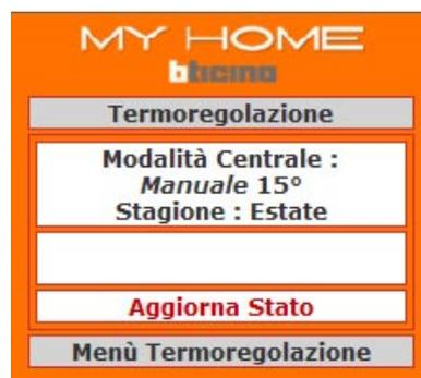
La segnalazione della totalità delle zone in modalità "Manuale" viene segnalata sulle pagine Web e sulla Centrale esclusivamente con la scritta "Manuale" ed il valore di temperatura impostato, senza alcuna altra icona.
