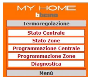
I primi due pulsanti interrogano lo stato dell'impianto, il terzo e il quarto impostano i parametri di impianto e l'ultimo effettua una diagnostica dell'impianto.
