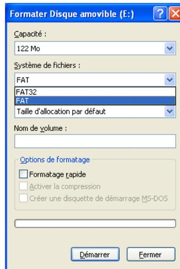
4. Nel riquadro « Sistema dei File », selezionare l'opzione FAT e non FAT32 che non è compatibile con l'oscilloscopio.
