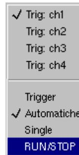
RUN/STOP permette l'avvio e l'arresto dell'acquisizione a partire da questo menu. Lo stato dell'acquisizione è indicato nella zona di stato dello schermo.
