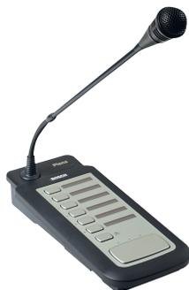
La stazione di chiamata PLN-6CS è un dispositivo remoto per effettuare annunci alle zone selezionate di All-in-One System. È possibile collegare un massimo di sei stazioni di chiamata all'unità All-in-One mediante una configurazione a catena "daisy-chain", tramite cavi CAT-5 con connettori RJ45.
