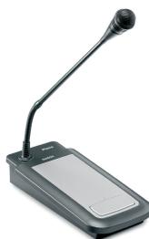
La stazione di chiamata PLE-1CS o PLE-1SCS è una stazione di chiamata a tutte le zone che consente di effettuare annunci con l'unità All-in-One senza sezionare zone. Viene collegata all'unità All-in-One attraverso un cavo CAT-5 schermato con connettori RJ45.
