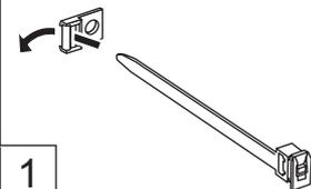
Per fissare i cavi collegati ai terminali, avvolgere la fascetta di fissaggio dei cavi intorno ad essi e quindi fare passare l'estremità appuntita attraverso la sezione di bloccaggio, come indicato nella figura.
