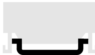
Fig. 3 Guida Omega: DIN 46277/ 3
