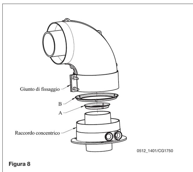
**L'inserimento di una curva a 90° riduce la lunghezza totale del condotto di 0,5 metri.
