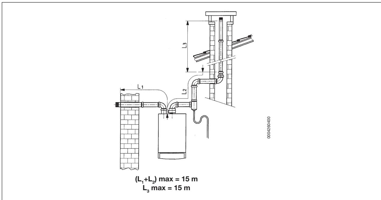
Questo tipo di condotto può essere utilizzato, in alternativa al diametro 80 mm, esclusivamente per la parte terminale del condotto stesso rispettando le seguenti condizioni:
