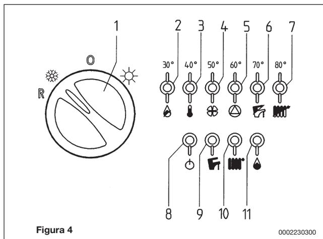
Le segnalazioni 2÷7 visualizzano la temperatura raggiunta dall'impianto di riscaldamento. In caso di anomalia viene visualizzato, mediante una segnalazione LAMPEGGIANTE, il tipo di anomalia.
