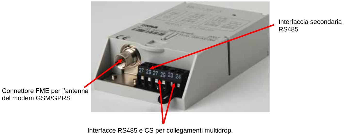
Fig. 30: Modulo di comunicazione GSM
