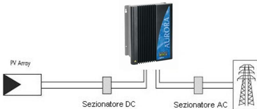
Fig.3 Diagramma semplificato di un sistema fotovoltaico
