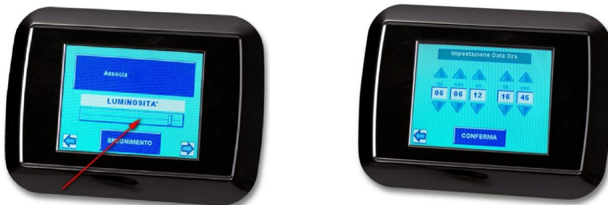
Qualora il SILFAB ENERGY STATION non fosse connesso ad Internet, la regolazione dell'ora sul SILFAB ENERGY STATION VIEW può essere effettuata sulla apposita maschera di "Impostazione data ora". In caso di blackout o di interruzione di alimentazione al SILFAB ENERGY STATION sarà necessario reimpostare nuovamente l'ora. Senza l'impostazione dell'ora il SILFAB ENERGY STATION non memorizza i dati storici dell'impianto.
