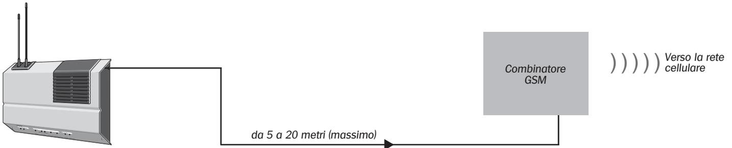
In caso d'allarme, l'uscita relè della centrale attiva l'ingresso E1 del combinatori cellulare GSM. L'autoprotezione ed il controllo tensione del combinatori telefonico GSM sono attivi.
