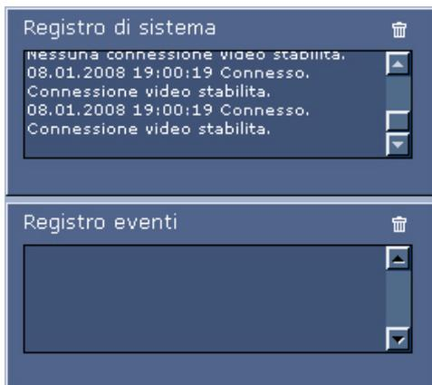
Il campo **Registro di sistema** contiene informazioni sullo stato operativo del modulo VIP X1600e della connessione. È possibile salvare automaticamente i messaggi in un file (vedere *Paragrafo 5.32 Configurazione pagina iniziale*, Pagina 85).
