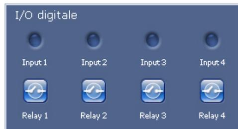
Le icone di allarme da **Input 1** a **Input 4** sono a scopo informativo e indicano lo stato di un ingresso di allarme. Quando viene attivato un allarme, l'icona corrispondente si illumina in blu. La visualizzazione dell'allarme e di altri eventuali dettagli dipende dalla configurazione del modulo (vedere *Paragrafo 5.32 Configurazione pagina iniziale*, Pagina 85).
