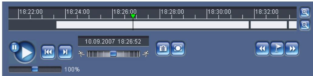
Per facilitare l'orientamento, sotto all'immagine video viene visualizzata una barra temporale. Se per la riproduzione è stata selezionata tramite clic una sequenza specifica, questa viene contrassegnata nell'elenco. L'intervallo di tempo associato viene visualizzato in grigio sulla barra. Una freccia verde sopra la barra indica la posizione dell'immagine attualmente riprodotta nella sequenza.
