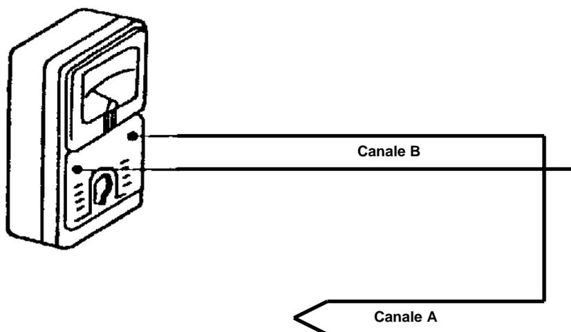
La resistenza in corrente continua del doppino del loop NON può superare i 40 Ohm.
