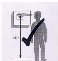
La centrale deve essere installata a muro in modo da permettere una chiara visibilità del display ed un facile accesso dell'operatore. Ad esempio, un'altezza di circa 1.5 m permette una visione ottimale del display.
