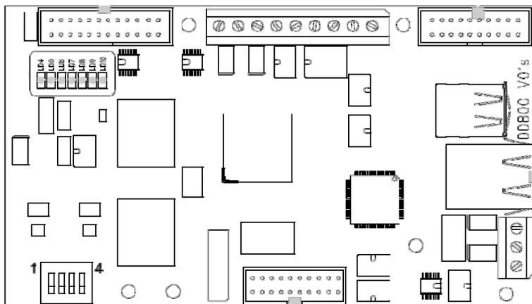
Scheda di comunicazione seriale (RS-232 oppure RS-485) per le nuove centrali AM2000, AM4000 e AM6000 con firmware con protocollo CEI 79.4 interfaccia per la connessione al software NOTI•FIRE•NET•2000•N e al sistema Euro-NET.
