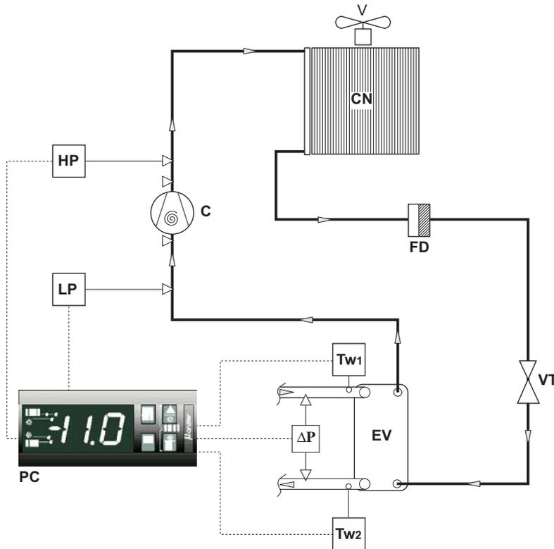
10.4 SCHEMA FRIGORIGERO POMPA DI CALORE VERSIONE ECHO H
