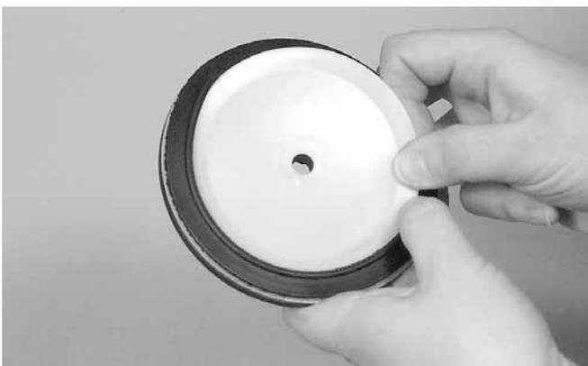
7. Inserire con cautela la rondella della tenuta sotto di chiusura della guarnizione.
