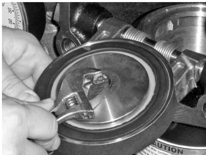
2. Rimuovere dalla tenuta del clapet l'assemblaggio bullone/tenuta del bullone.
