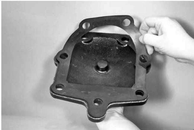
2. Allineare i fori della guarnizione ai fori della piastra di copertura.
