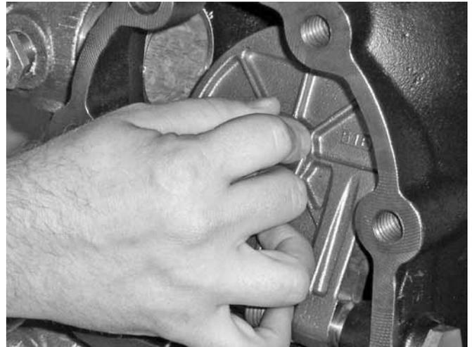
13. Ruotare il clapet facendolo fuoriuscire dal corpo della valvola. Ispezionare la tenuta del clapet e l'anello di ritegno della tenuta. Eliminare eventuali contaminanti, sporcizia e depositi di minerali presenti. Pulire eventuali fori ostruiti nell'anello in cui è alloggiata la valvola. **NON UTILIZZARE SOLVENTI O ABRASIVI.**
