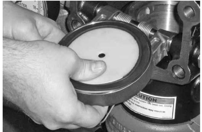
9. Facendo attenzione, installare la tenuta nel clapet. Accertare che l'anello della tenuta scatti completamente nel clapet.
