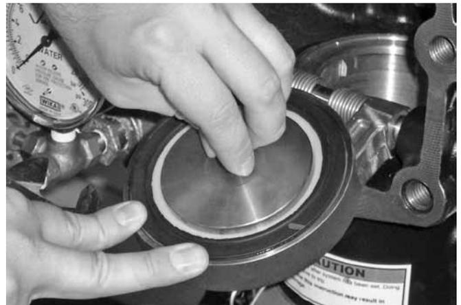
10. Posizionare il disco premiguarnizione sulla rondella della tenuta del clapet. Installare l'assemblaggio bullone/tenuta del bullone attraverso il disco premiguarnizione e il clapet.
