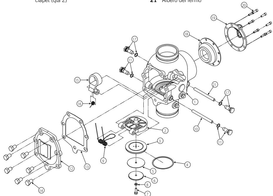
\* **NOTA:** le valvole da 48,3 mm/ 1 1/2" e 60,3 mm/2" sono dotate di rondelle sotto le teste o i bulloni della piastra di copertura
