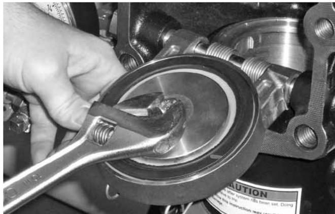
11. Per ottenere la tenuta corretta, serrare l'assemblaggio bullone/tenuta del bullone al valore di coppia elencato nella tabella di seguito.
