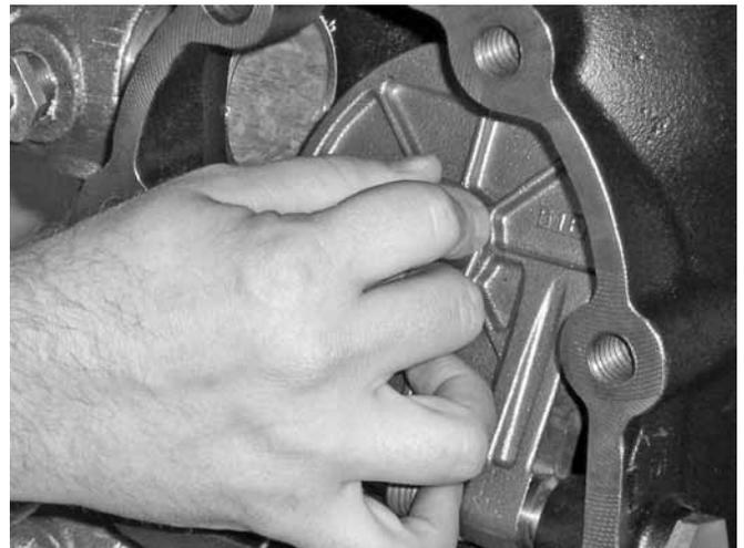
11. Controllare il clapet per verificare se si muove liberamente.
