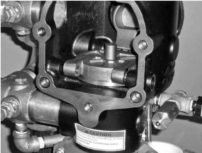
5. Mettere il nuovo assemblaggio del clapet sull'anello in cui è alloggiato il corpo della valvola. Controllare che i fori nei bracci del clapet siano allineati ai fori nel corpo della valvola.
