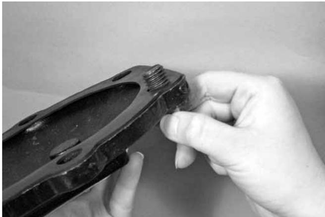
3. Per facilitare l'allineamento, inserire un bullone della piastra di copertura attraverso la piastra e la guarnizione. **NOTA:** per le valvole da 48,3 mm/ 1½" e 60,3 mm/2", è necessario installare una rondella sotto la testa di ogni bullone della piastra di copertura.
