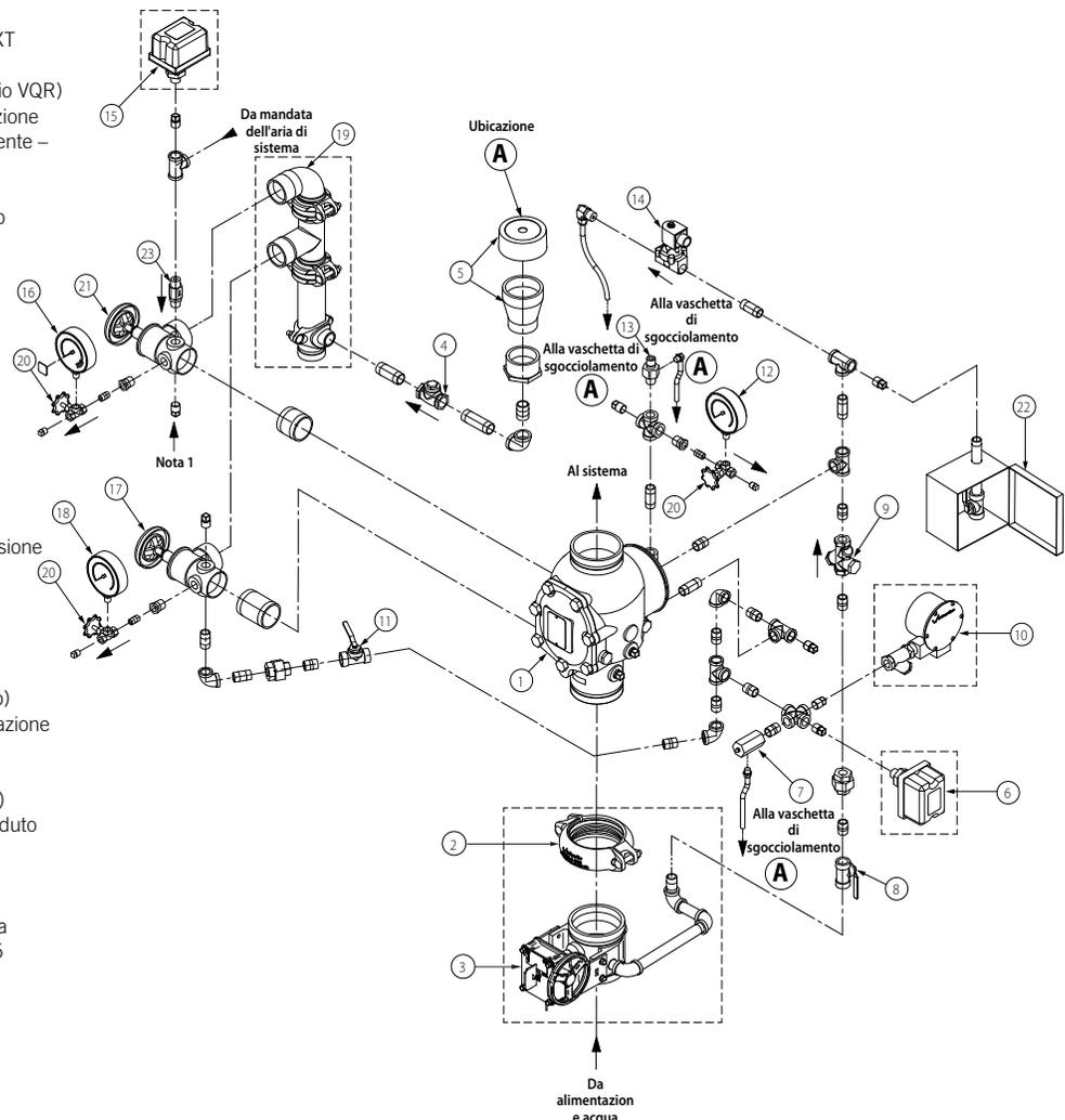
\*\*L'articolo n. 15 è opzionale/venduto separatamente (o standard se si ordina un assemblaggio VQR) per trim con interlock singolo a rilascio elettrico.
