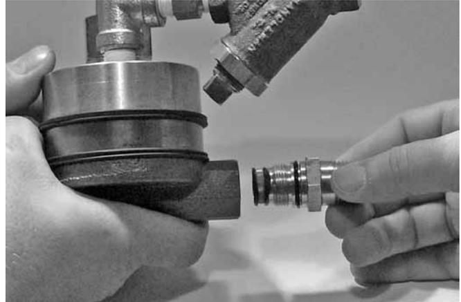
3. Rimuovere l'assemblaggio del filtro dall'attuatore a bassa pressione serie 776, come mostrato sopra. Eliminare solo lo schermo del filtro.
