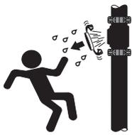
• Depressurizzare e drenare il sistema di tubazione prima di tentare l'installazione, la rimozione, la regolazione o la manutenzione di qualsiasi prodotto per tubazione Victaulic.
