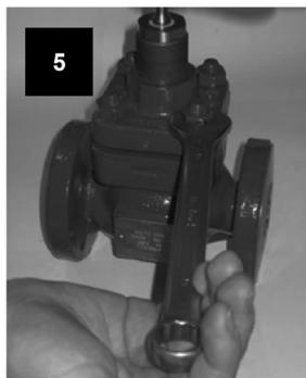
Con una chiave dinamometrica serrare lievemente ed uniformemente ogni bullone e dado di 45°, rispettando la sequenza illustrata in Fig. 22, pag. 38.
