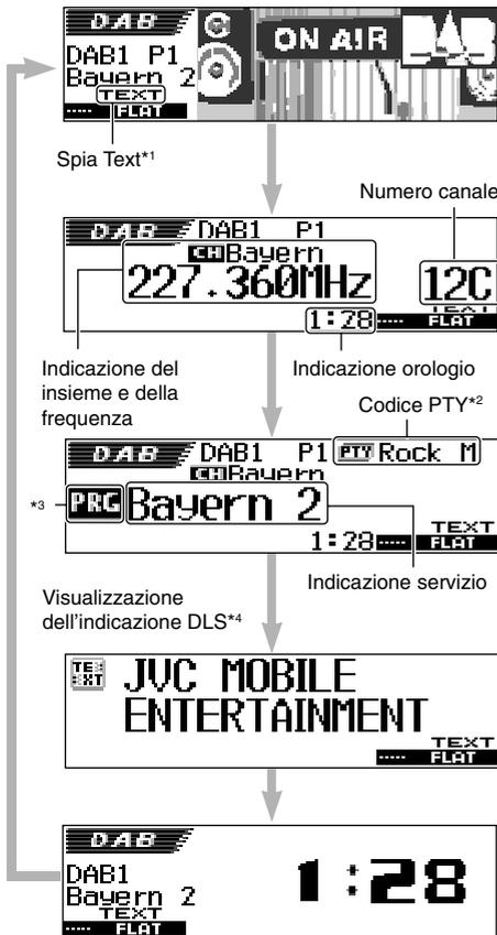
\*1 Spia TEXT: Indica che il servizio correntemente in ricezione fornisce segnali DLS (Dynamic Label Segment—Informazioni di testo radio DAB).
