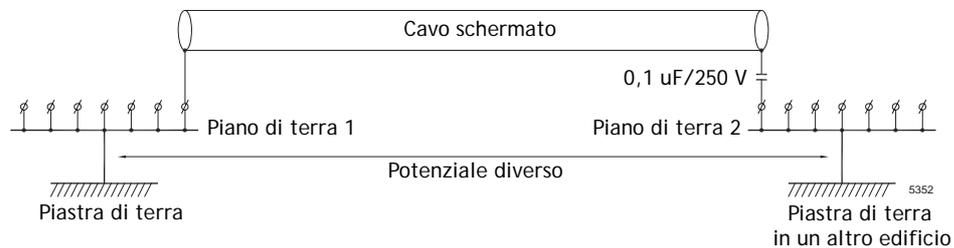
In presenza di distanze maggiori, vi è il rischio che il potenziale di terra sia diverso. In tal caso, la schermatura va collegata a una sola estremità. Una buona alternativa è il collegamento a terra dell'altra estremità della schermatura mediante un condensatore plastico da 0,1 uF/250 V. Entrambe le estremità vengono quindi collegate a terra in termini di alta frequenza, ma una sola è collegata a terra in termini di bassa frequenza, in modo da evitare ritorni di terra a 50 Hz.
