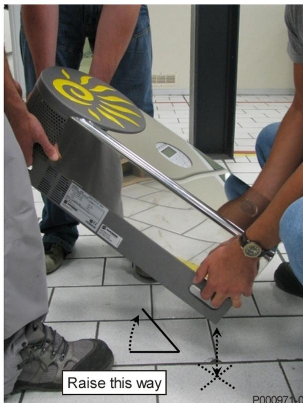
Figura 7: Esempio di movimentazione del SUNWAY M PLUS
