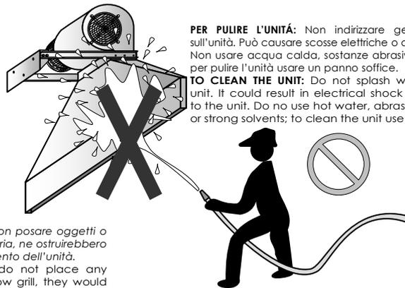
**PER PULIRE L'UNITÀ:** Non indirizzare getti d'acqua sull'unità. Può causare scosse elettriche o danneggiarla. Non usare acqua calda, sostanze abrasive o solventi; per pulire l'unità usare un panno soffice.
