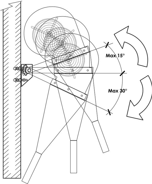
La staffa di sostegno orientabile (fornita standard assieme all'unità) consente una varietà di inclinazioni diverse a seconda delle caratteristiche del portone sul quale viene posizionata.
