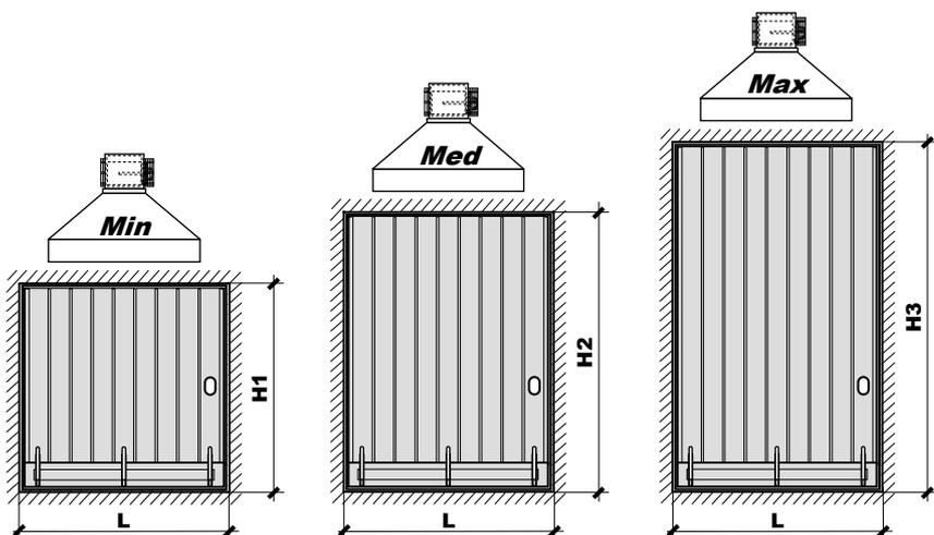
Il ventilatore a 3 velocità consente di variare la potenza di emissione dell'aria in funzione dell'altezza del portone.
