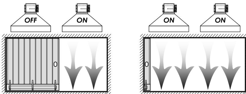
Un adeguato schema elettrico (con sensore di contatto apertura portone) permette di attivare la barriera ad ogni apertura e/o solo la barriera di interesse a seconda del grado di apertura del portone.
