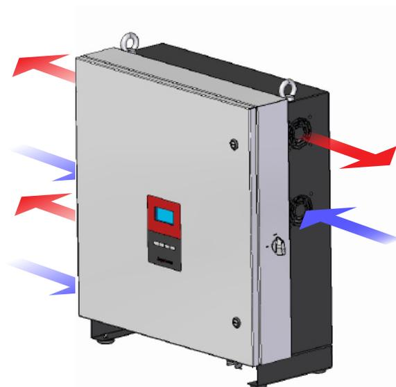
È necessario lasciare uno spazio libero minimo di 30 cm nella zona superiore del dispositivo, in quella inferiore e sui lati, e di 80 cm nella parte frontale, per poter aprire la porta. Solo in questo modo il sistema di raffreddamento del dispositivo funzioner  in modo corretto.
