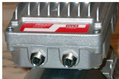
*Particolare della versione "/F" dotata di connettori stagni per segnali di comando e terminale ALS-1 o seriale RS-485.*
