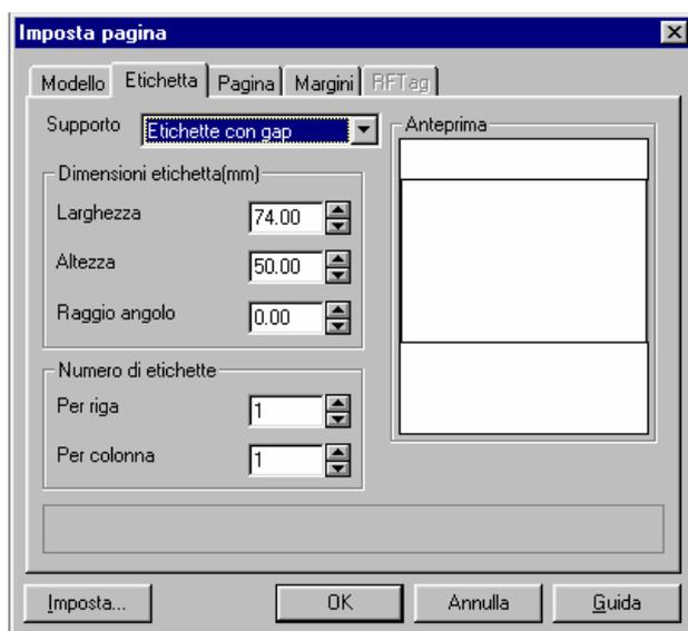
La prima informazione da dare è quella di definire la tipologia di Supporto di stampa per il sincronismo dell'etichetta (le stampanti termiche riconoscono l'inizio di ogni etichetta per evitare disallineamenti) che per default è **Etichette con Gap** cioè etichette autoadesive con la rilevazione dell'inizio etichetta tramite il riconoscimento dell'interspazio tra due etichette (la stessa selezione si usa con cartellini semirigidi che abbiamo un intaglio o foro di sincronismo).
