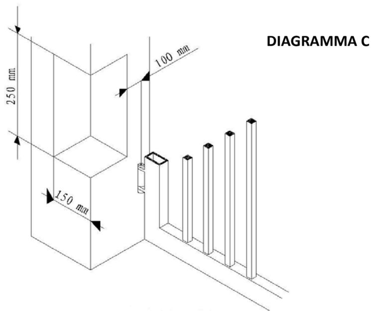
Se il pilastro di supporto del cancello è in metallo allora saldare la piastra di supporto dell'apricancello direttamente al pilastro, se invece trattasi di pilastro in calcestruzzo o mattoni allora fissare la piastra tramite appositi tasselli e bulloni quindi saldare la staffa alla piastra.
