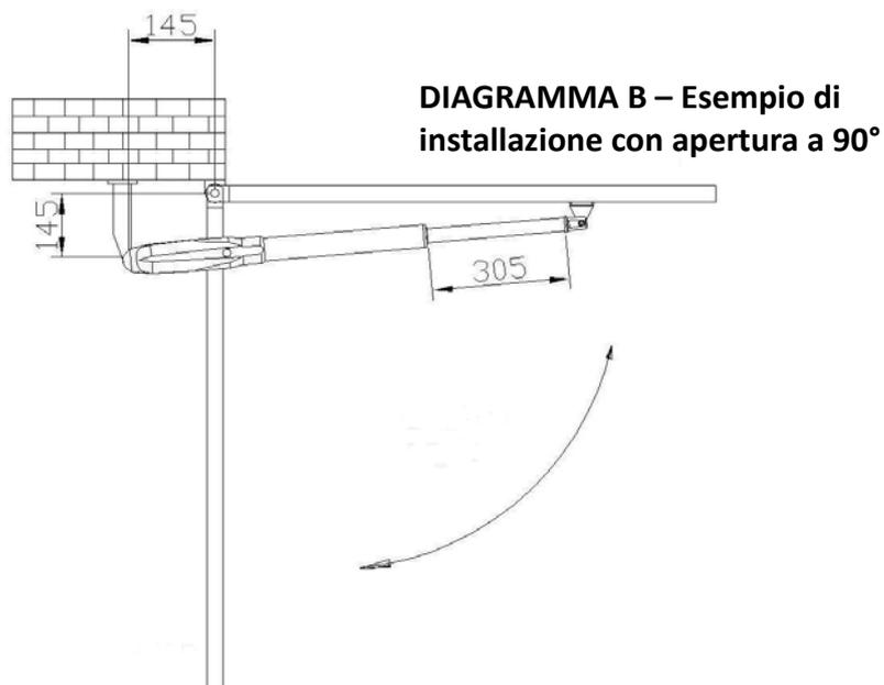
Cambiando le misure indicate dal Diagramma A, l'angolo di apertura cambierà di conseguenza ( $90^\circ \leq \alpha \leq 110^\circ$ ).
