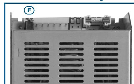
7. Tramite un tester misurare la tensione sui terminali +AUX della scheda della centrale e ruotare il trimmer [F] dell'alimentatore fino ad ottenere il valore di tensione individuato nel punto precedente.
